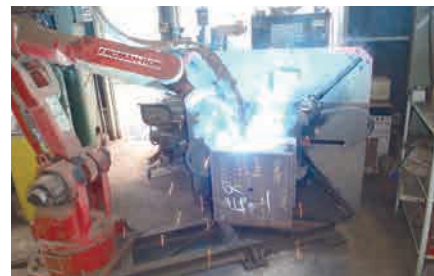
溶接ロボット
